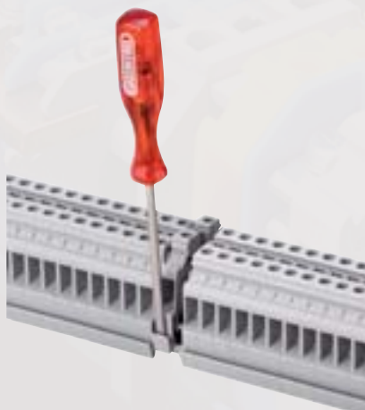
4. Auswechseln einzelner Klemmen: Nachdem die auszuwechselnde Klemme durch geringes Abrücken der Nachbarklemmen (je ca. 3mm) freigesetzt ist, kann diese mit einer leichten Hebelbewegung mittels eines Schraubenziehers auf den Klemmenfuß ausgerastet werden.
