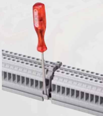
4. Remplacement des blocs individuels: Après avoir libéré le bloc à échanger par écarter un peu le bloc de jonction à côté (envr. 3 mm à chaque direction) il est possible d'enclencher la borne avec un tournevis par un petit mouvement du levier sur le pied du bloc de jonction.
