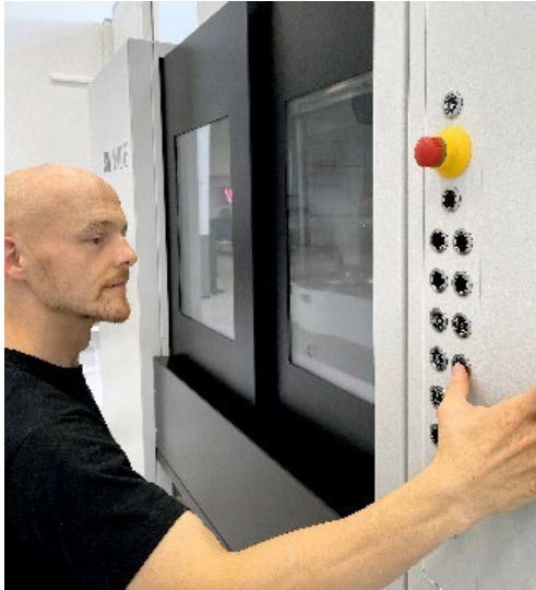
Das HMI kommt an zentralen Stellen der Maschinen zum Einsatz, um die Werkstückbeladung zu steuern oder für die Steuerung der Werkzeugbeladeeinrichtung. Foto: Schwäbische Werkzeugmaschinen GmbH (SW)
